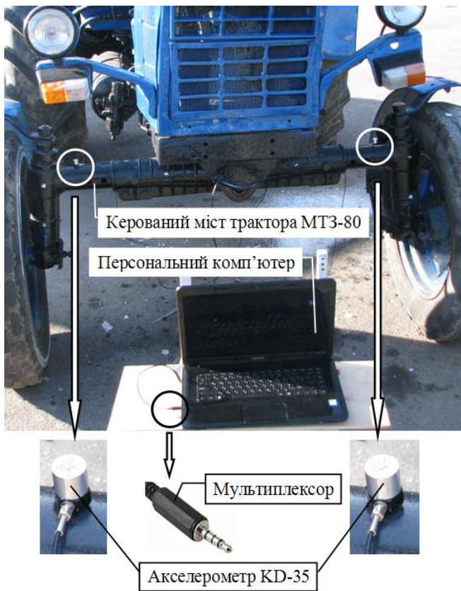
Рисунок 1 – Система діагностування керованих мостів колісних тракторів: а – загальний вигляд; б – структурна схема: 1 – керований міст трактора; 2, 3 – акселерометри; 4 – мультиплексор; 5 – аналого-цифровий перетворювач; 6 – обчислювальний пристрій; 7 – монітор; 8 – пристрій друкування
