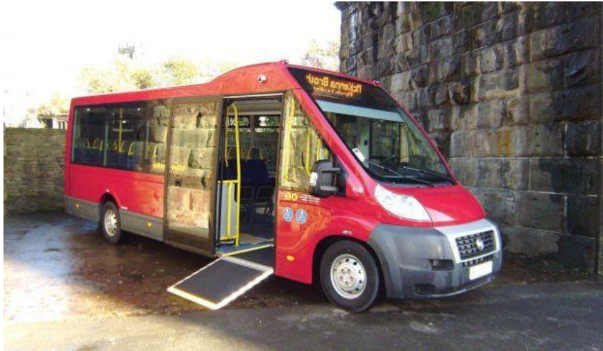
Рисунок 2 – Низькопідлоговий мікроавтобус з пониженням несучої основи (Low-floor)
