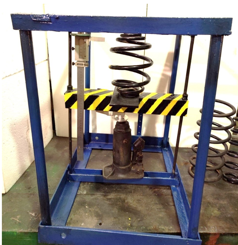
Рис. 1. Стенд для контролю характеристик пружин
