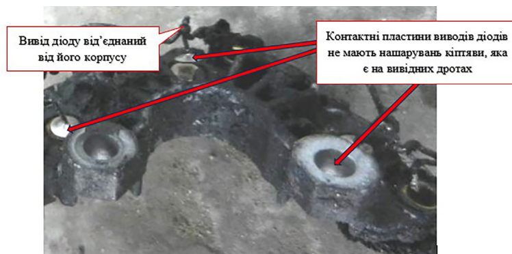
Рисунок 4. Діодний блок (випрямлювач), що був встановлений у генераторі змінного струму автомобіля, який досліджується
