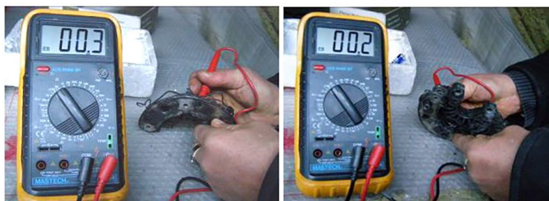
Рисунок 5, 6. Процес вимірювання провідності діоду, вивід якого від'єднаний від його корпусу
