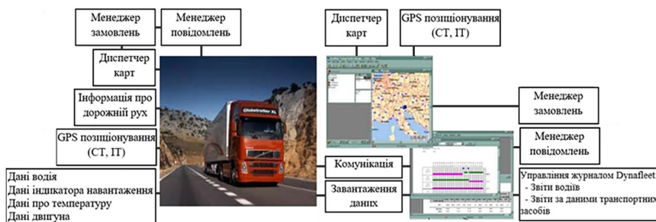
Рисунок 1. Структурна схема системи моніторингу транспорту Dynafleet
