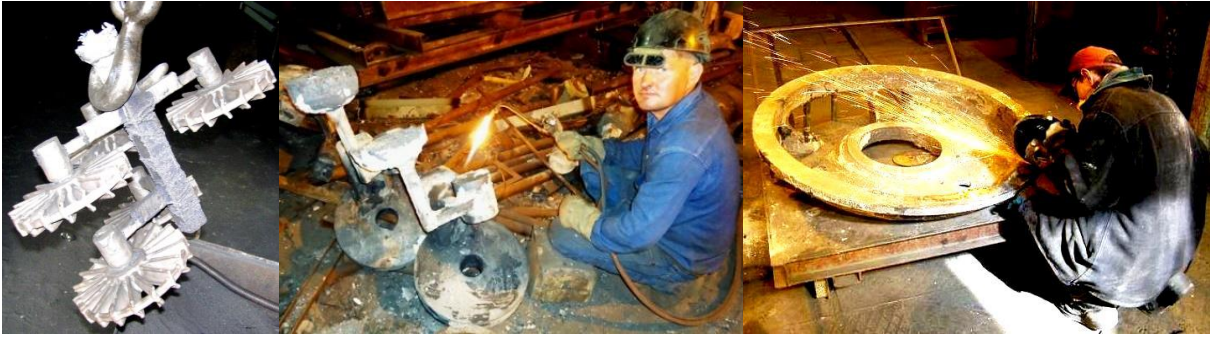
Рис. 4. Видалення краном виливків із форми, обрізання на виливках ливників та очисні операції
