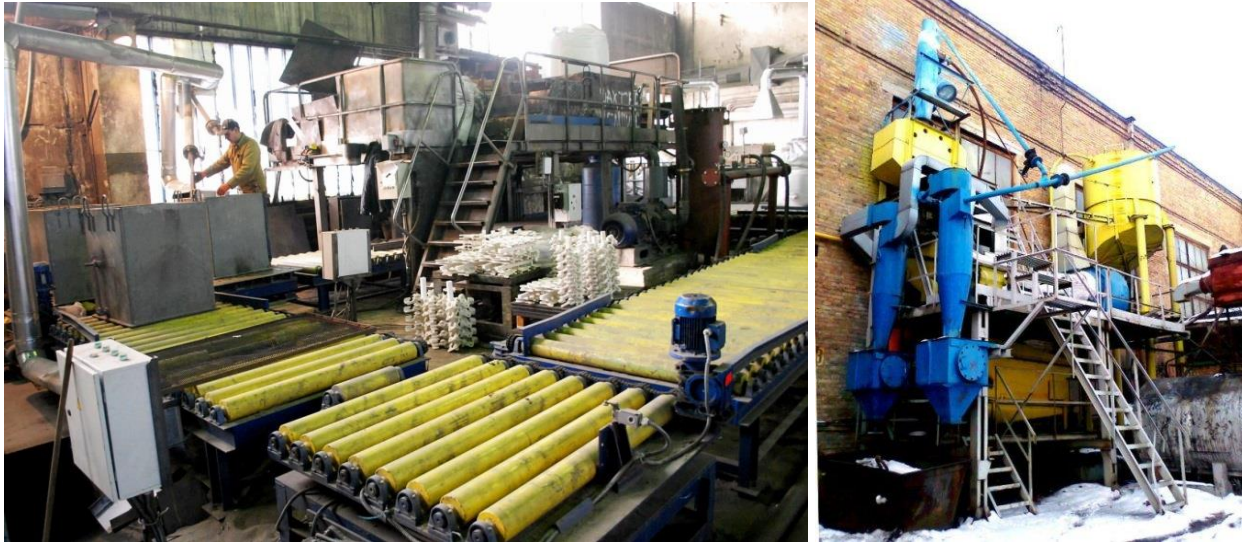
Рис. 5. Обладнання ливарних конвєсєрів рольгангами та лінія регєнерації піску ззовні ливарного цеху
