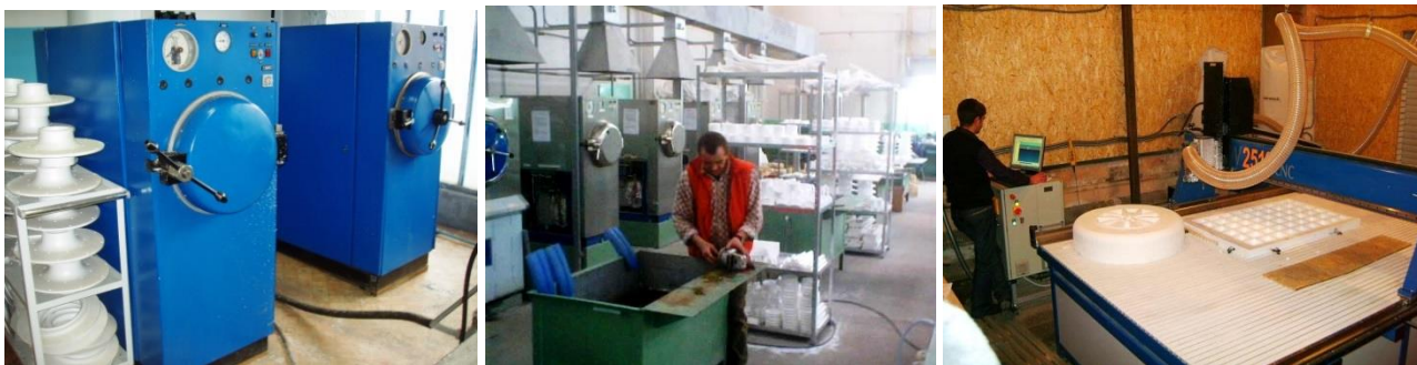
Рис. 1. Приклади обладнання модельних дільниць цеху ЛГМ для виготовлення разових моделей з пінополістиролу (ППС) на автоклавах та станку з ЧПУ (3D-фрезері)
