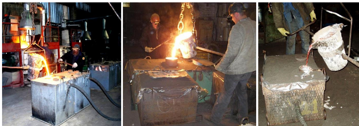
Рис. 3. Приклади заливання металом піщаних форм з вакуумуванням цих форм (тут бачимо відсутність газовиділення в робочу зону цеху)
