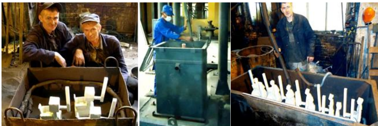
Рис. 2. Приклади формувальної оснастки – контейнерів та операцій формування за моделями з ППС
