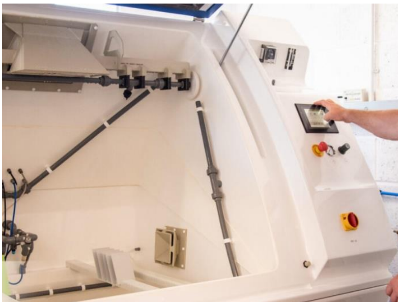
Рис. 3. Камера для випробування на циклічну корозію з тестовими зразками всередині
