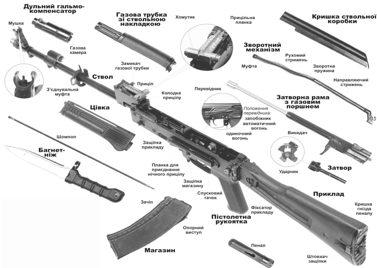
Рисунок 2 – Основні частини і механізми автомата АК-74М [1]
