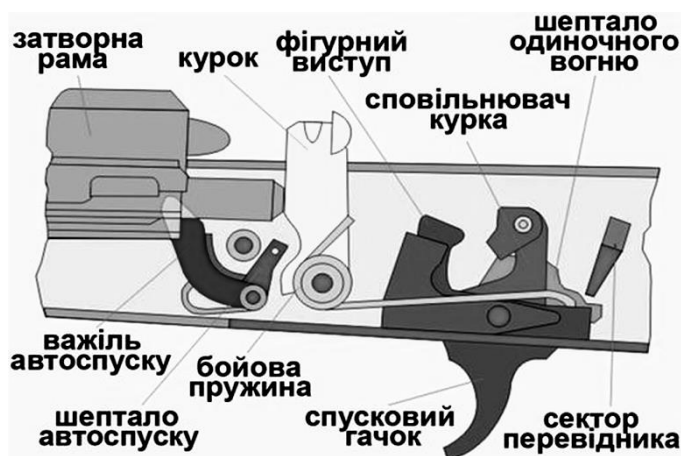
Рисунок 3 – Ударно-спусковий механізм автомата Калашникова [1]
