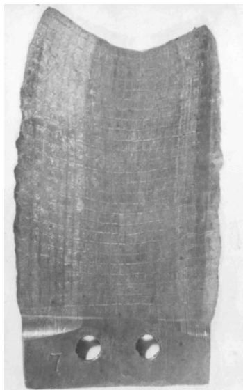
Рисунок 2 – Прямокутна у поперечному перерізі заготовка, вальцьована з підвищеним обтискуванням на крайках
