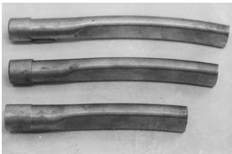
Рисунок 1 – Заготовки з криволінійною віссю після вальцювання в гладких вальцювальних штампах
